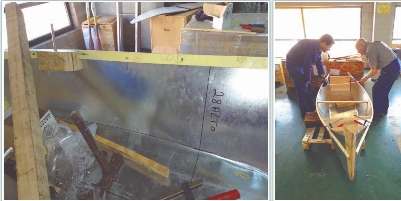
4. A continuación se colocan los cintones internos y externos .
